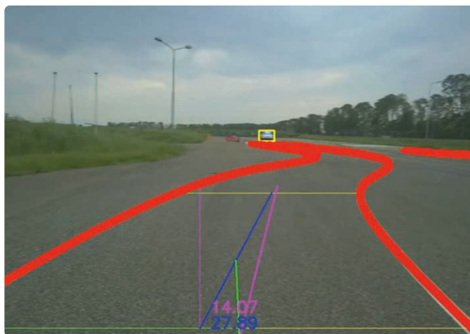
Figuur 7. YOLOPv2-lijndetectie plus onze stuurvectorberekening.
